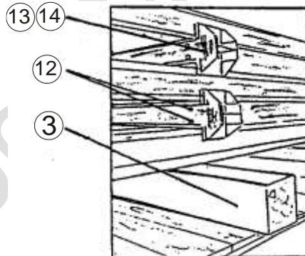
Ad eccezione delle superfici di bloccaggio del giogo, il coefficiente d'attrito delle superfici di scorrimento deve essere ridotto mediante provvedimenti idonei (p.es.: prodotti lubrificanti adeguati, inserti in materiale sintetico).
