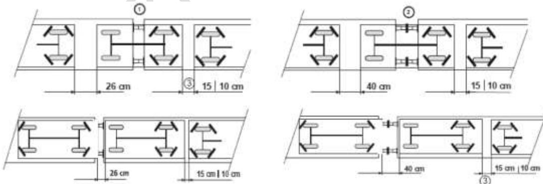
Lo spazio libero minimo nel senso verticale tra tutti i punti del tetto del veicolo (comprese sovrastrutture, antenne, accessori, ecc.) e la parte inferiore del piano di carico superiore e nel senso trasversale deve essere di 8 cm.
