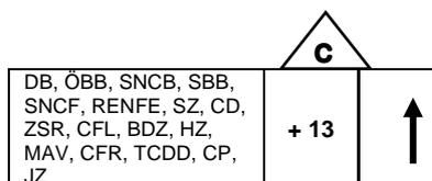
Sul piano di appoggio superiore (caviglie ribaltabili in posizione attiva), possono essere caricate CM in base alla metodo di carico 9.1. L'utilizzazione vincolante del piano di carico superiore viene qui prescritta mediante il simbolo ↑
