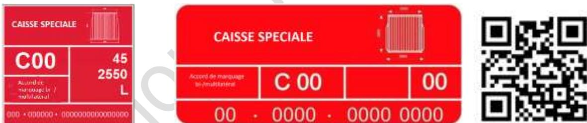
I dati sulla placca comprendono il codice del profilo e la larghezza secondo UIC 596-6 / IRS 50596-6 nonché indicazioni sulla categoria di lunghezza e sul numero dell'accordo bi / multilaterale (Esempio di carico) [L'emissione delle targhette di codifica può essere effettuata solo da enti autorizzati \(organismo di valutazione della conformità secondo IRS 50596-6, appendice H.1, tabella 1\).](#)
