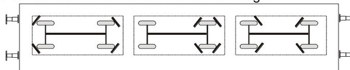
I veicoli caricati al di sopra un accoppiamento corto o di un accoppiamento permanente devono essere assicurati su un solo asse con quattro calzatoie di bloccaggio.
