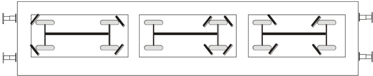
E' preferibile eseguire l'assicurazione a livello di un asse, se possibile l'asse posteriore
