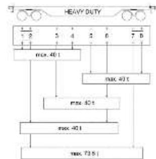
Sul carro è apposto uno schema di carico con la marcatura delle caviglie rinforzate
