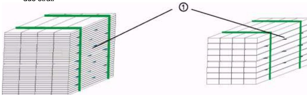
I pacchi fino a 4,5 m di lunghezza vanno fissati con almeno 2 legature a pacco e con una legatura supplementare per ogni parte posteriore di 1,5 m.
