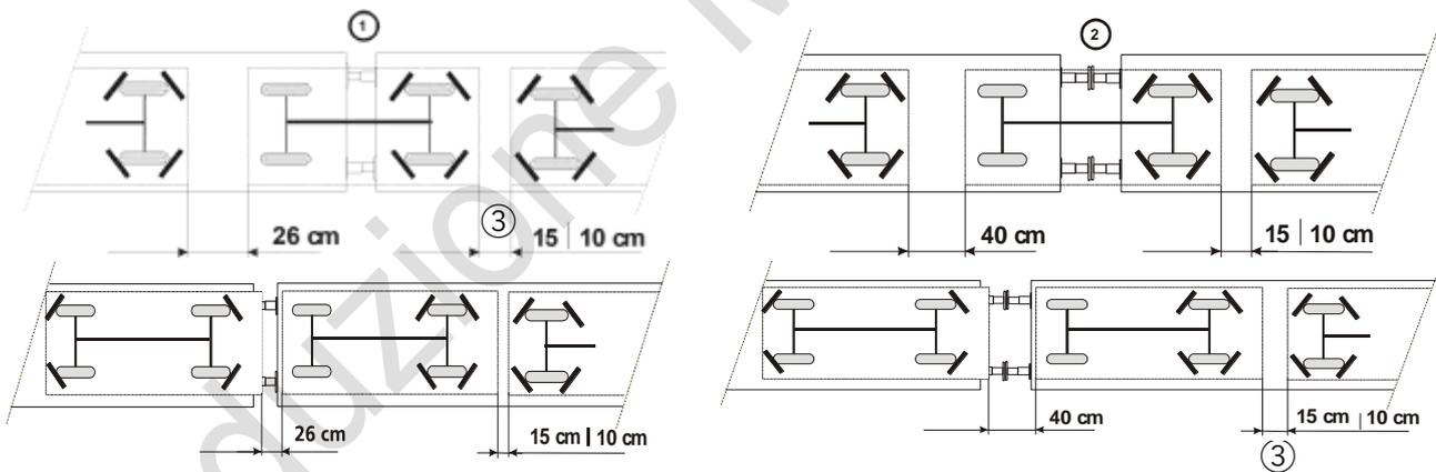
Spazio libero minimo in senso verticale fra il tetto del veicolo e la parte inferiore della piattaforma di carico superiore, così come nel senso trasversale del carro: 8 cm.
