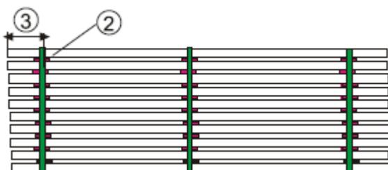
Sforzo di rottura in trazione diritta della legatura a pacco: 1000 daN, per cui nei punti di giunzione, in caso di utilizzazione di cinghie in polietilene (PET), deve essere soddisfatto almeno l'80% dello sforzo di rottura in trazione diritta. Sforzo di pretensionamento minimo 300 daN.
