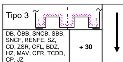
Sul piano di carico inferiore (caviglia ribaltabile aperta), la costruzione autorizza unicamente il carico delle CM tipo 3. L'utilizzazione obbligatoria del piano di carico inferiore è imposta dal simbolo ↓
