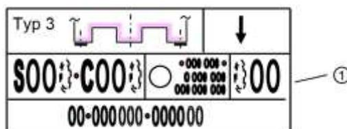
① Alla CM viene attribuito un codice di lunghezza, in funzione delle distanze tra la mezzeria dei blocchi d'angolo, delle lunghezze esterne e delle sporgenze. Questo codice di lunghezza deve essere considerato nel posizionamento della CM sul carro tenendo conto dello schema di carico corrispondente.
